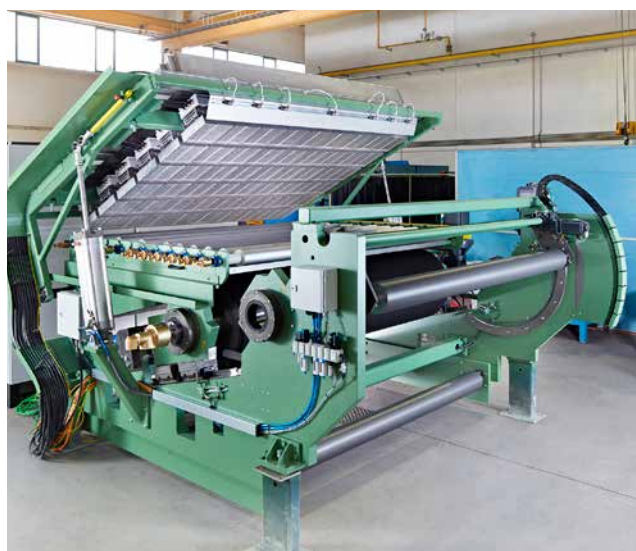
Préchauffage infrarouge KRELUS pour les gaufreuses Source : Kampf LSF GmbH, Laussig, Allemagne
