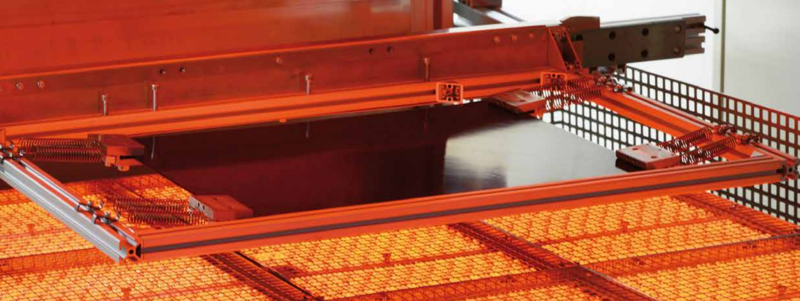
Chauffage homogène d'une feuille organo Source : Fraunhofer IPT
