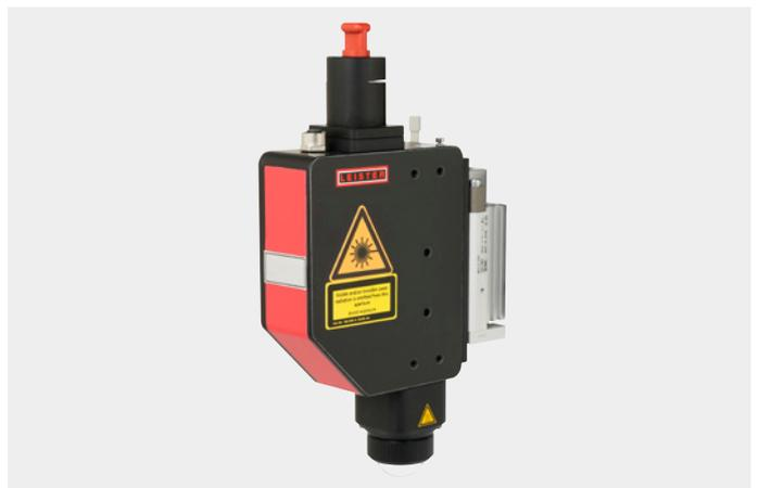
Con Globo Optic, la saldatura in 2-D o 3-D è possibile senza una complessa tecnologia di serraggio. La sfera di vetro con cuscinetto ad aria focalizza il raggio laser e funge da strumento di pressione meccanica. Mentre la sfera rotola sul componente, preme completamente e localmente sul piano di giunzione. Ciò significa che la radiazione laser colpisce solo in presenza di pressione di contatto.
