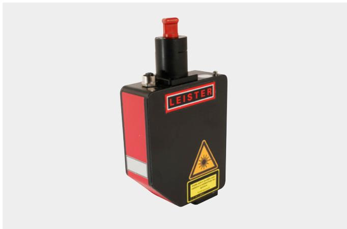
L'ottica Spot focalizza il raggio laser su un punto e viene utilizzata principalmente per la saldatura di contorni. Le lunghezze focali degli obiettivi di messa a fuoco utilizzati determinano il diametro del punto laser, che a sua volta determina l'ampiezza del cordone di saldatura. Il raggio laser può quindi essere adattato alle esigenze individuali della saldatura delle materie plastiche sostituendo i componenti ottici.
