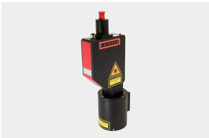
Con l'ottica Radiale è possibile la saldatura laser senza rotazione senza dover ricorrere a serraggio supplementare. La saldatura radiale è adatta per componenti a rotazione simmetrica che sono difficili da ruotare da soli. La radiazione laser viene deviata sulla circonferenza dei componenti da uno specchio conico. Ciò consente di saldare contemporaneamente componenti con un diametro fino a  $\varnothing 68$  mm. I vantaggi sono i tempi di ciclo brevi e l'elevata produttività.
