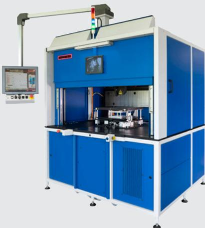
MAXI è un sistema di saldatura laser modulare, universalmente applicabile e specializzato in componenti di grandi dimensioni. Può essere equipaggiato in molti modi diversi come stazione di lavoro manuale e può essere adattata alle applicazioni e ai processi specifici del cliente.
