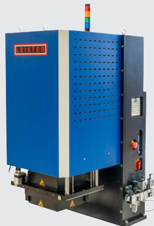
L'Inline Welder è un sistema di integrazione laser-secure per le linee di produzione per la saldatura di contorni 2D utilizzando l'ottica Scanner. Modulare, poco ingombrante e con componenti decentralizzati. Ideale per tavoli rotanti di indicizzazione/linee di trasferimento.
