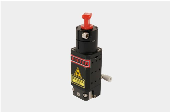
L'ottica Roller non richiede alcuna tecnologia di serraggio supplementare. Nell'ottica Roller un raggio laser lineare viene guidato attraverso un rullino in vetro, che è sia lo strumento di serraggio che l'ultimo elemento ottico. Il rullo bilaterale è in grado di produrre cordoni di saldatura di circa 3.0-6.7 mm. Il cuscinetto autoallineante del rullo compensa le piccole irregolarità in direzione assiale.
