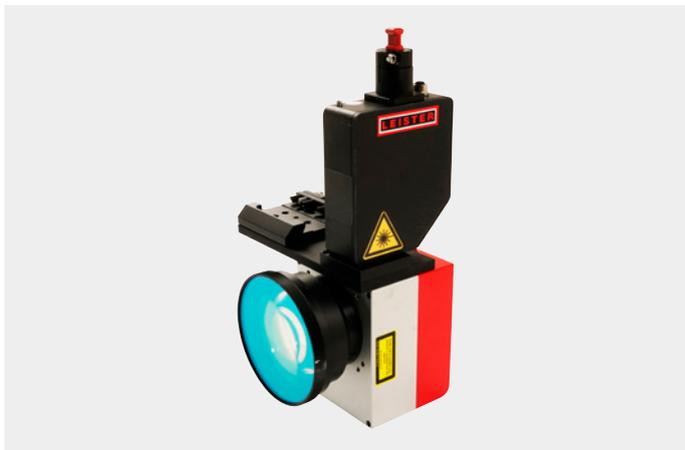
L'ottica Scanner è caratterizzata dall'opzione integrata di movimento ed è utilizzata principalmente per la saldatura quasi simultanea. Due specchi mobili guidano un raggio laser a forma di punto lungo un contorno stabilito. La dimensione del campo di lavoro può essere regolata da diverse lenti di messa a fuoco. L'ottica Scanner può essere installata in vari sistemi di saldatura laser Leister S/M/L.
