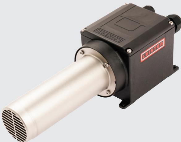
Il LHS 41L CLASSIC ha un tubo di riscaldamento più lungo ed è disponibile con una potenza di 2, 4.4 o 5.5 kW. È dotato di rilevamento del surriscaldamento dell'elemento riscaldante e dell'apparecchio con contatto di allarme. Può essere perfettamente integrato nel circuito di controllo tramite SSR.
