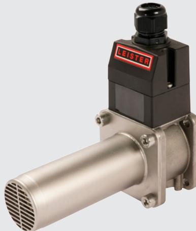
Il LHS 410 SF è disponibile con una potenza di 2, 3.6, 4.4 o 5.5 kW e può essere dotato di vari ugelli. Con un SSR, il riscaldatore d'aria può essere integrato in un circuito di controllo che utilizza un segnale PWM.
