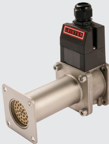
Il LHS 410 DF è disponibile con una potenza di 2, 3.6, 4.4 o 5.5 kW. La flangia ne facilita l'installazione nei sistemi di tubazioni. Con un SSR, il riscaldatore d'aria può essere integrato in un circuito di controllo mediante un segnale PWM.
