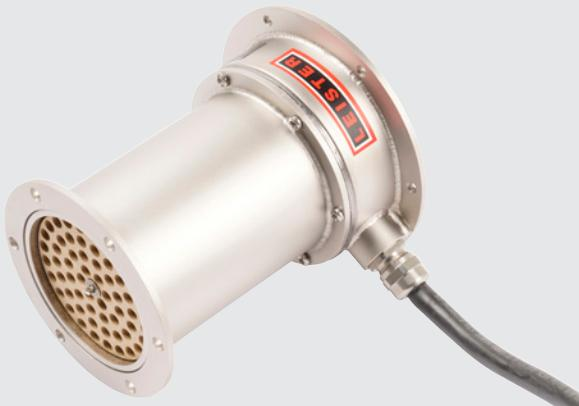
Il LE 10000 DF ha una potenza di riscaldamento di 5.5, 8, 11, 16 o 17 kW. Raggiunge una temperatura massima di uscita dell'aria di 650 °C e può funzionare con una temperatura di ingresso fino a 150 °C. È adatto per essere integrato nei sistemi di canalizzazione dell'aria.
