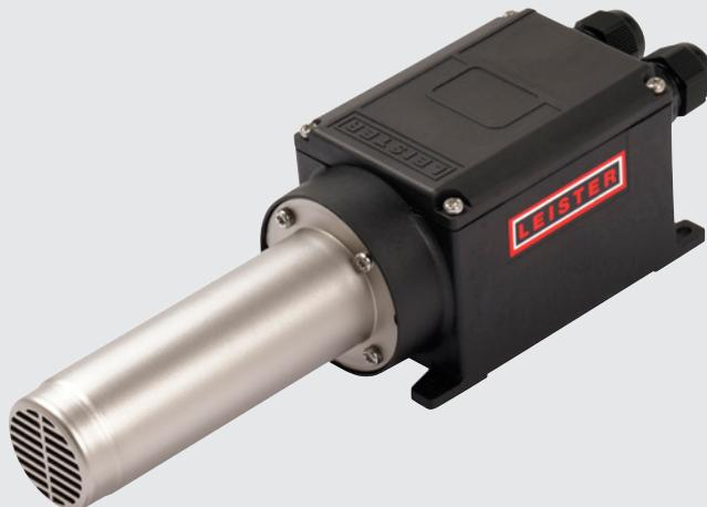
Il LHS 21S CLASSIC è disponibile con una potenza di 1 o 2 kW. È dotato di rilevamento del surriscaldamento dell'elemento riscaldante e dell'apparecchio con contatto di allarme. Può essere perfettamente integrato nel circuito di controllo tramite SSR.
