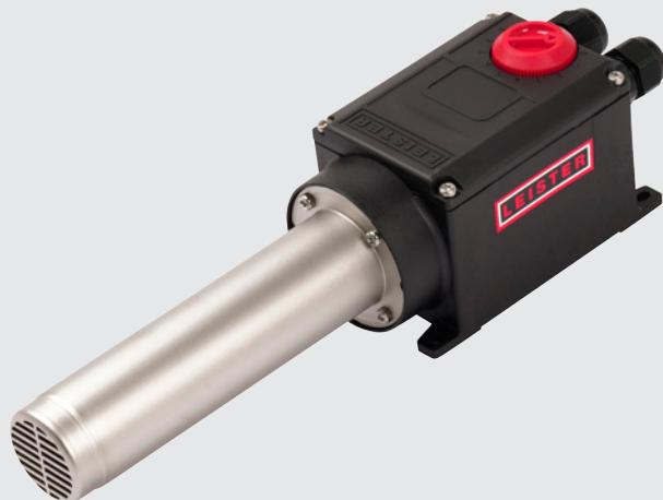
Il LHS 21L PREMIUM 3.3 kW ha un tubo di riscaldamento più lungo. È dotato di una protezione contro il surriscaldamento dell'elemento riscaldante e dell'apparecchio con un contatto di allarme. La potenza di riscaldamento è regolabile in continuo tramite un potenziometro sull'apparecchio.
