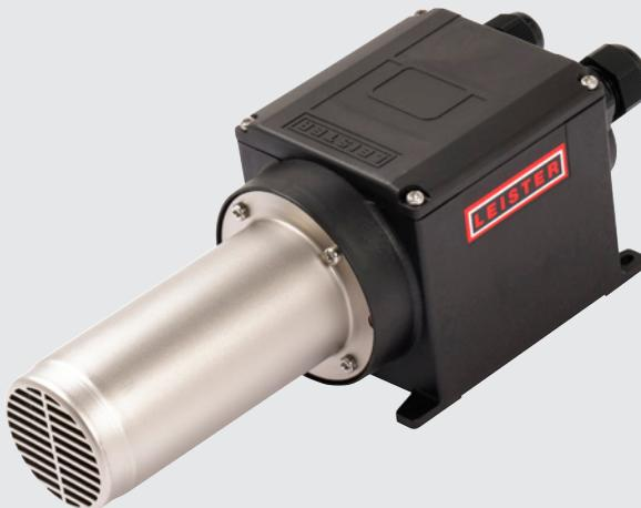
Il LHS 41S CLASSIC è disponibile con una potenza di 2 o 3.6 kW. È dotato di rilevamento del surriscaldamento dell'elemento riscaldante e dell'apparecchio con contatto di allarme. Può essere perfettamente integrato nel circuito di controllo tramite SSR.
