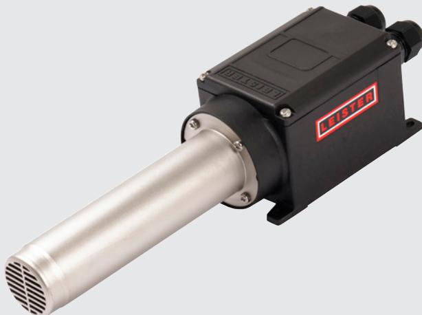
Il LHS 21L CLASSIC 3.3 kW ha un tubo di riscaldamento più lungo. È dotato di rilevamento del surriscaldamento dell'elemento riscaldante e dell'apparecchio con contatto di allarme. Può essere perfettamente integrato nel circuito di controllo tramite SSR.
