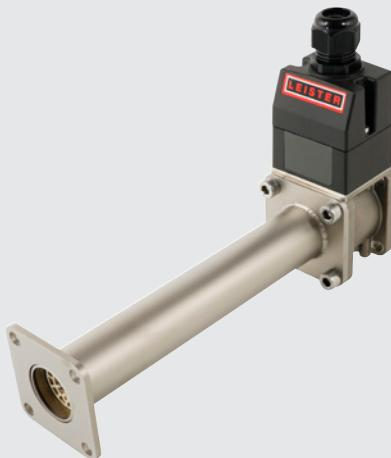
Il LHS 210 DF HT ha una potenza di 3.3 kW, raggiunge una temperatura massima dell'aria in uscita di 900 °C e la flangia ne facilita l'installazione nei sistemi di tubazioni. Con un SSR, il riscaldatore d'aria può essere integrato in un circuito di controllo tramite un segnale PWM.
