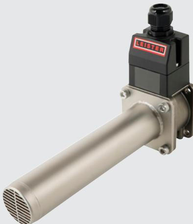
Il LHS 410 SF HT ha una potenza di 4.4 o 5.5 kW, una temperatura massima dell'aria in uscita di 900 °C e può essere dotato di vari ugelli. Con un SSR, il riscaldatore d'aria può essere integrato in un circuito di controllo utilizzando un segnale PWM.
