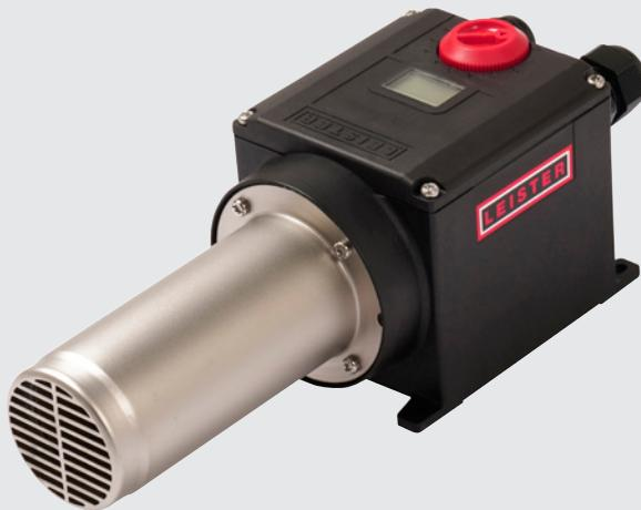
Il LHS 41S SYSTEM è disponibile con una potenza di 2 o 3.6 kW. Dispone di un display per visualizzare i valori impostati/reali, di un'interfaccia per il controllo remoto e di una protezione contro il surriscaldamento dell'elemento riscaldante e dell'apparecchio con contatto di allarme.
