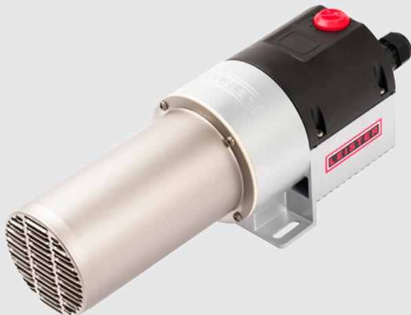
Il LHS 61L CLASSIC è disponibile con una potenza di 5, 8, 10, 11 o 16 kW. È dotato di rilevamento del surriscaldamento dell'elemento riscaldante e dell'apparecchio con contatto di allarme. Può essere perfettamente integrato nel circuito di controllo tramite SSR.
