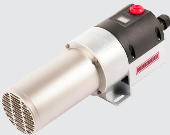
Il LHS 61L SYSTEM è disponibile con una potenza di 5, 8, 10, 11 o 16 kW. Dispone di un display per visualizzare i valori impostati/reali, di un'interfaccia per il controllo remoto e di una protezione contro il surriscaldamento dell'elemento riscaldante e dell'apparecchio con contatto di allarme.
