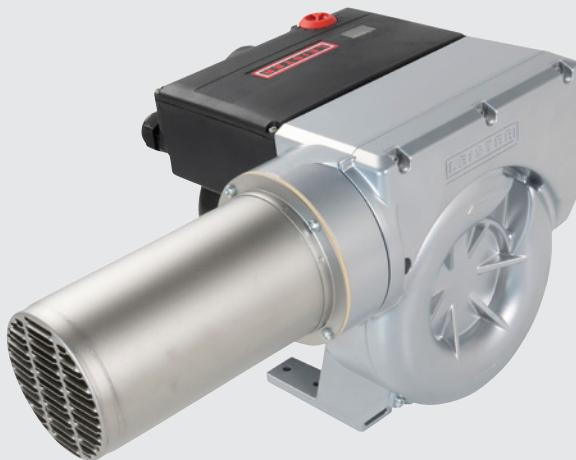
Il VULCAN SYSTEM 10/11 kW ha una capacità di riscaldamento di 10/11 kW e una protezione integrata contro il surriscaldamento dell'elemento riscaldante e dell'apparecchio. Grazie all'interfaccia analogica standard, il soffiatore d'aria calda può essere controllato anche a distanza.
