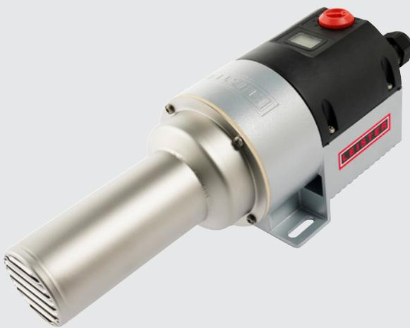
Il LHS 61S SYSTEM è disponibile con una potenza di 4, 6, 8, 8.5 o 9 kW. Dispone di un display per visualizzare i valori impostati/reali, di un'interfaccia per il controllo remoto e di una protezione contro il surriscaldamento dell'elemento riscaldante e dell'apparecchio con contatto di allarme.
