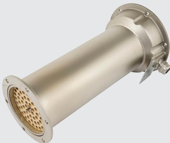
Il LE 10000 DF HT ha una capacità di riscaldamento di 15 o 22 kW. Raggiunge una temperatura massima di uscita dell'aria di 900 °C e può funzionare con una temperatura di ingresso fino a 150 °C. È adatto per essere integrato nei sistemi di canalizzazione dell'aria.
