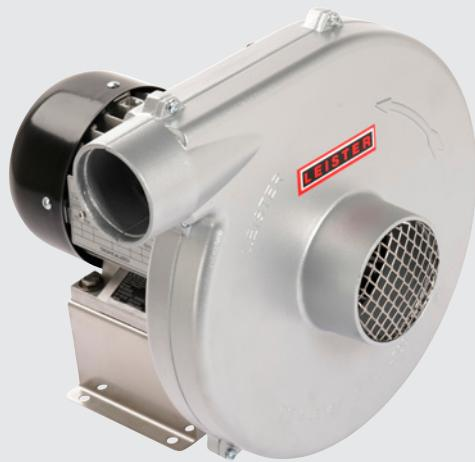
La soffiatore SILENCE, compatto e resistente, è stato progettato appositamente per l'uso in linee di produzione con temperature di ingresso dell'aria da 100 a 200 °C. Funziona senza problemi a temperature ambiente fino a un massimo di 75 °C.
