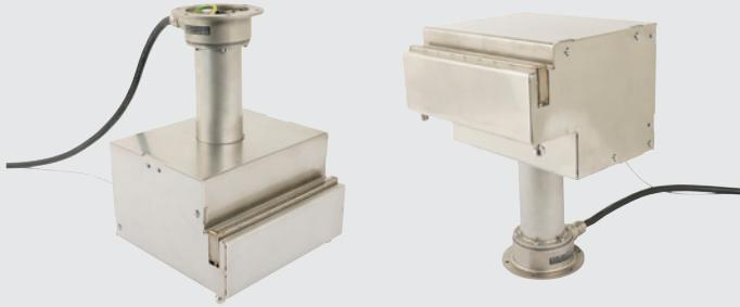
Le unità di saldatura per la sigillatura longitudinale di imballaggi in cartone per bevande con aria calda sono disponibili in due versioni: LE 5000 HT-U e LE 5000 HT-S. È possibile raggiungere velocità di produzione fino a 700 m/min a una temperatura massima di 900 °C.
