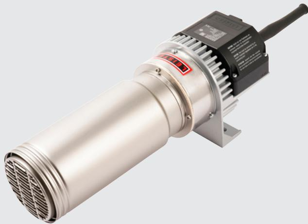
Il LE 10000 HT ha una potenza di riscaldamento di 15 kW. Raggiunge una temperatura massima dell'aria in uscita di 900 °C e può funzionare con una temperatura di ingresso fino a 100 °C. Il riscaldatore d'aria può essere dotato di vari ugelli.
