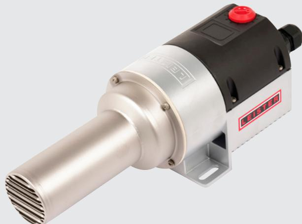
Il LHS 61S CLASSIC è disponibile con una potenza di 4, 6, 8, 8.5 o 9 kW. È dotato di rilevamento del surriscaldamento dell'elemento riscaldante e dell'apparecchio con contatto di allarme. Può essere perfettamente integrato nel circuito di controllo tramite SSR.
