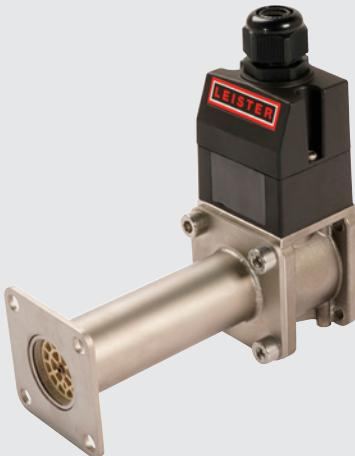
Il LHS 210 DF è disponibile con una potenza di 1, 2 o 3.3 kW. La flangia ne facilita l'installazione nei sistemi di tubazioni. Con un SSR, il riscaldatore d'aria può essere integrato in un circuito di controllo utilizzando un segnale PWM.
