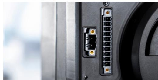
Interfaccia con contatto di allarme per il controllo della portata d'aria e della potenza termica, con segnale da 4-20 [mA] o 0-10 [V] (SYSTEM)
