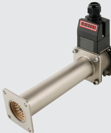
Il LHS 410 DF HT ha una potenza di 4.4 o 5.5 kW, una temperatura massima dell'aria in uscita di 900 °C e la flangia ne facilita l'installazione nei sistemi di tubazioni. Con un SSR, il riscaldatore d'aria può essere integrato in un circuito di controllo tramite un segnale PWM.
