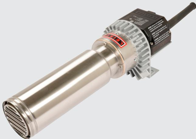
Il LE 5000 HT ha una potenza di riscaldamento di 11 kW. Raggiunge una temperatura massima dell'aria in uscita di 900 °C e può funzionare con una temperatura in ingresso fino a 100 °C. Il riscaldatore d'aria può essere dotato di vari ugelli.
