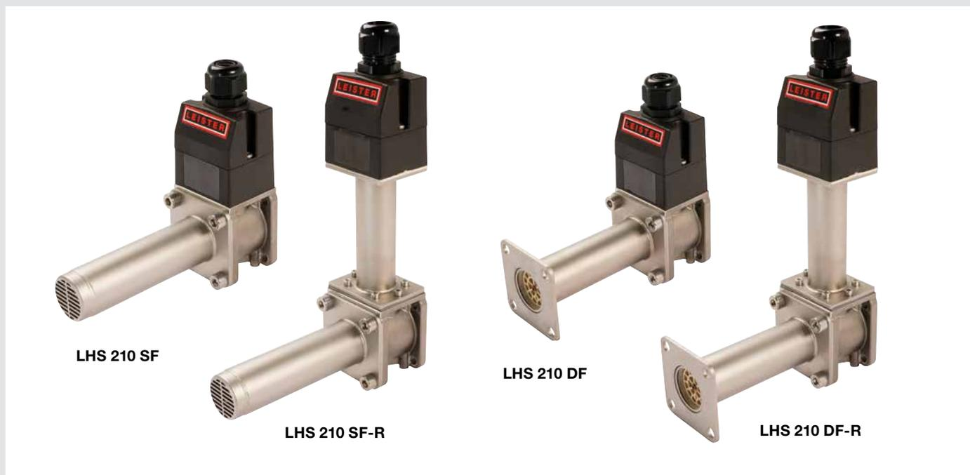
L'attacco dell'alloggiamento dell'LHS 210 si trova all'esterno del flusso d'aria, permettendo a questa di fluire attraverso il riscaldatore senza ostacoli e una perdita di pressione praticamente nulla. Inoltre, il collegamento dell'alloggiamento LHS 210 SF-R e DF-R è protetto contro il surriscaldamento, rendendo possibile lavorare con temperature di ingresso dell'aria fino a 350°C.
