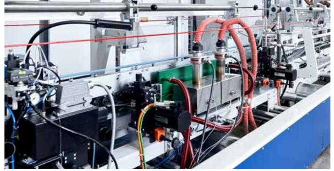
Le unità di pre-sigillatura consistono in 2 dispositivi LE 5000 HT-U, che sono utilizzati nella sezione di pre-sigillatura della macchina mostrata da Fortuna GmbH.
