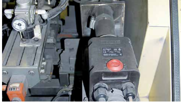
LHS 40Lヒーターによるチャコール フィルターエレメントからのホイル スリーブの除去
