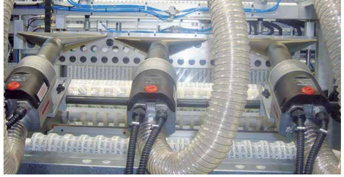
ラッピングラインにおける幅広スロット ノズル付きの3台のLHS ヒーター
