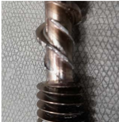
操作不当:焊接丝带入了一些小石子,导致螺丝受损。
