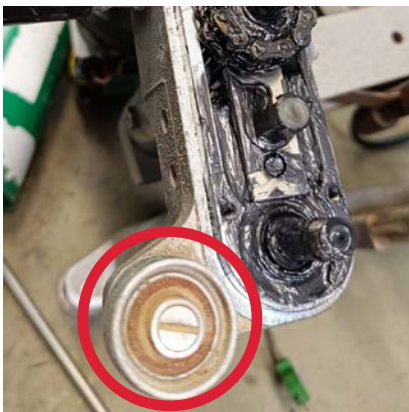
运动部件的腐蚀
