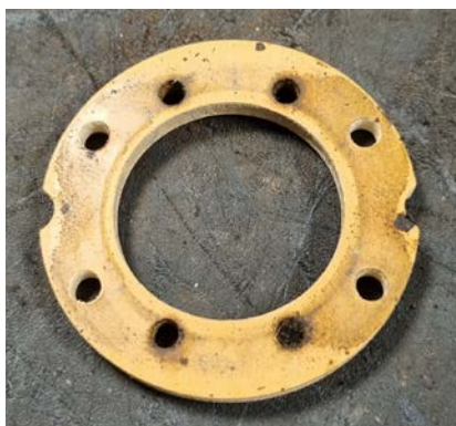
垫片 由热反射引起的磨损(发黄)。
