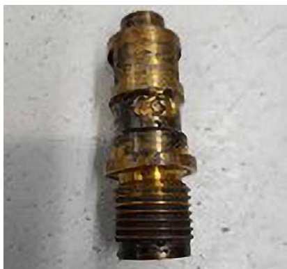
喷嘴(挤出机) 客户安装的焊接鞋导致了压痕。
