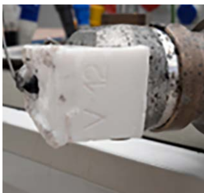
焊靴 焊接鞋因频繁使用而磨损。
