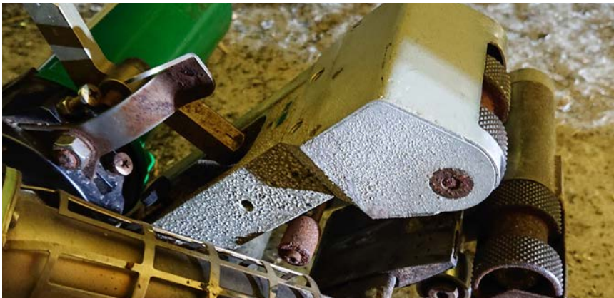
PVC焊接引起的腐蚀
