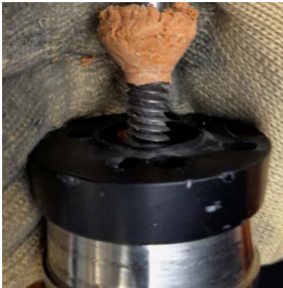
操作不当:两根焊丝被同时插入,导致塑料被挤了回去。
