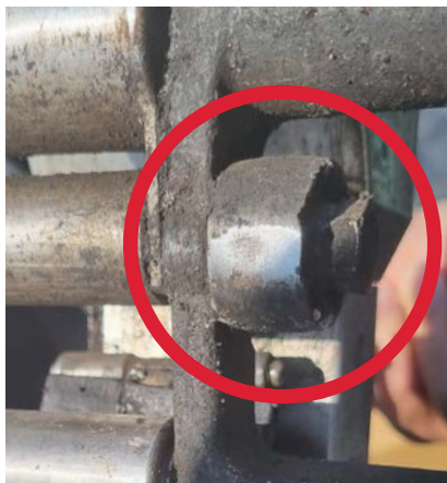
重度污垢 严重的污垢堆积会导致轴承堵塞并影响其正常运转
