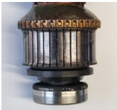
转子/换向器 经过多次更换碳刷后, 集电器出现正常磨损。
