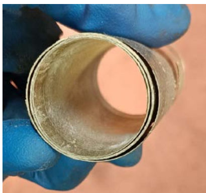
云母管 因频繁受高温加热(来自加热元件的热量)而造成的磨损。
