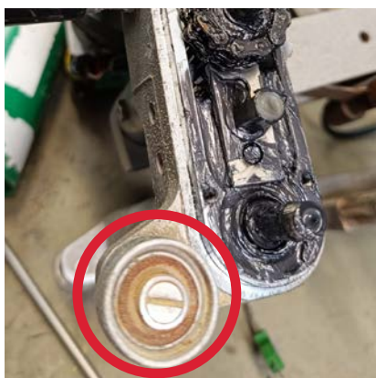
Коррозия движущихся частей
