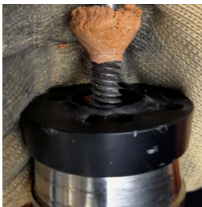
Неправильное обращение: Два сварочных провода были вплетены вместе, из-за чего пластик отталкивался назад.
