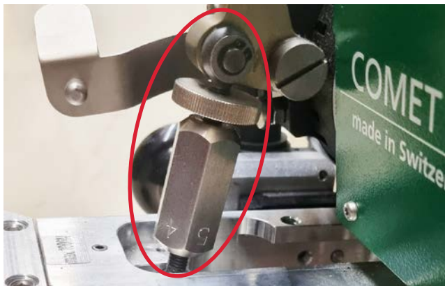
Parafuso de ajuste de pressão torto devido à pressão de união excessiva em dispositivos GEO (imagem não mostra dano)
