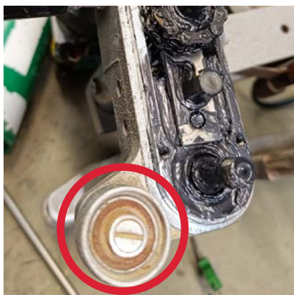
Corrosão de peças móveis
