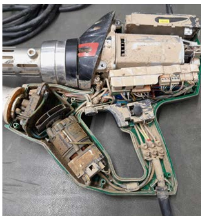
Falta de manutenção, dispositivo muito sujo
