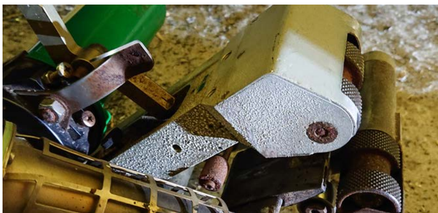
Corrosão causada pela soldagem de PVC
