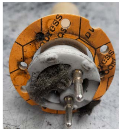
Filter niet geïnstalleerd
