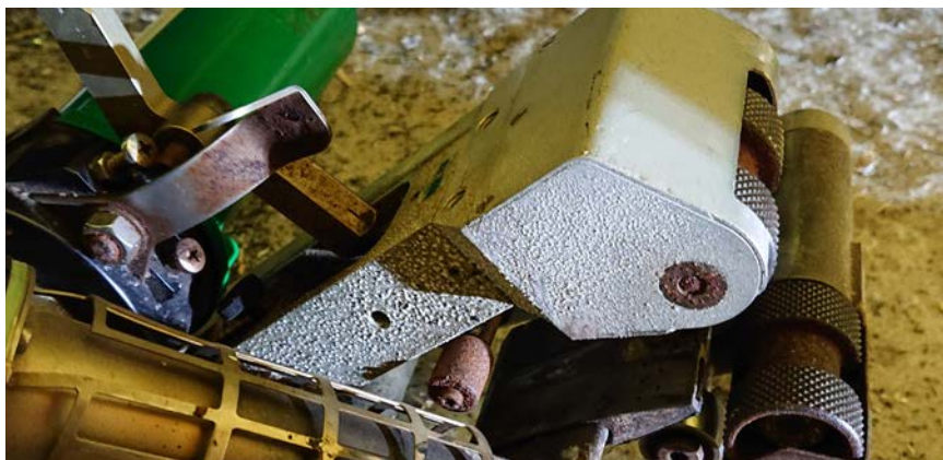
Corrosie veroorzaakt door lassen van PVC
