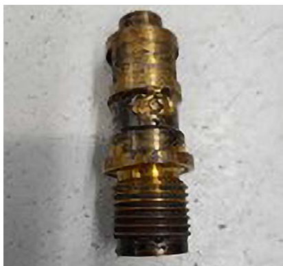
ノズル（押出機） 顧客による溶接シュウの取り付けにより、へこみが生じる。
