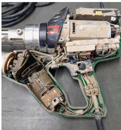
保守・点検不足により、装置が著しく汚れている
