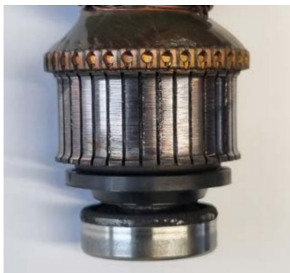
ローター／コミュテーター カーボンブラシを繰り返し交換した後に生じるコミュテーターの通常摩耗。
