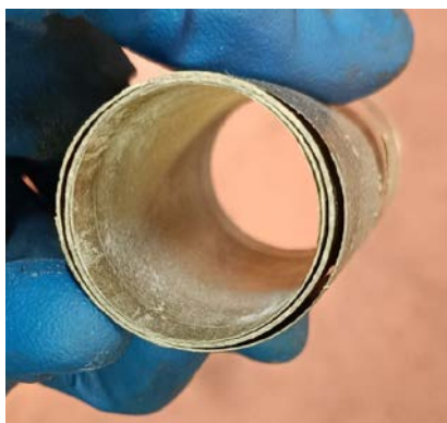
マイカチューブ ヒートティングエレメントからの熱により頻繁に高温加熱されることによる摩耗。
