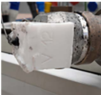
溶接シュウ 頻繁な使用による溶接シュウの摩耗。
