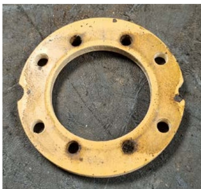
ガスケット 反射熱による摩耗（黄色への変色）。
