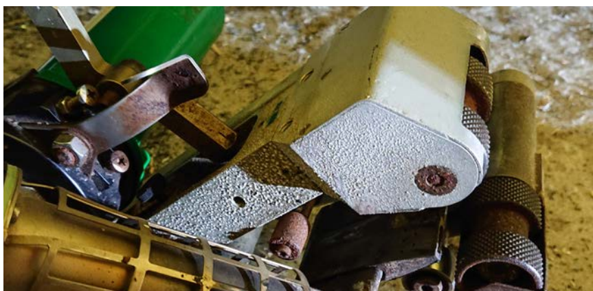
PVC溶接による腐食
