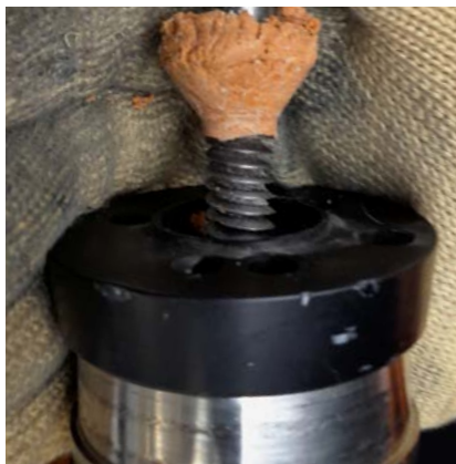
不適切な取扱い:2本の溶接ワイヤーが同時に挿入され、プラスチックが押し戻された。
