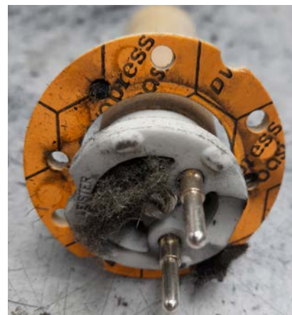
Filtro non installato
