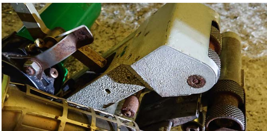
Corrosione causata dalla saldatura del PVC
