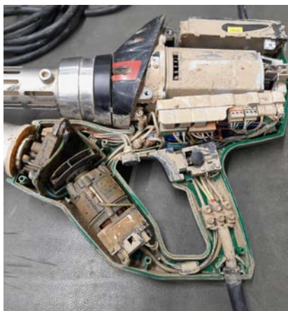
Mancanza di manutenzione, dispositivo molto sporco
