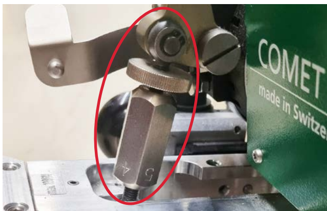
Vite di regolazione della pressione piegata a causa di un'eccessiva pressione di saldatura nelle saldatrici GEO (il danno non è visibile nell'immagine)
