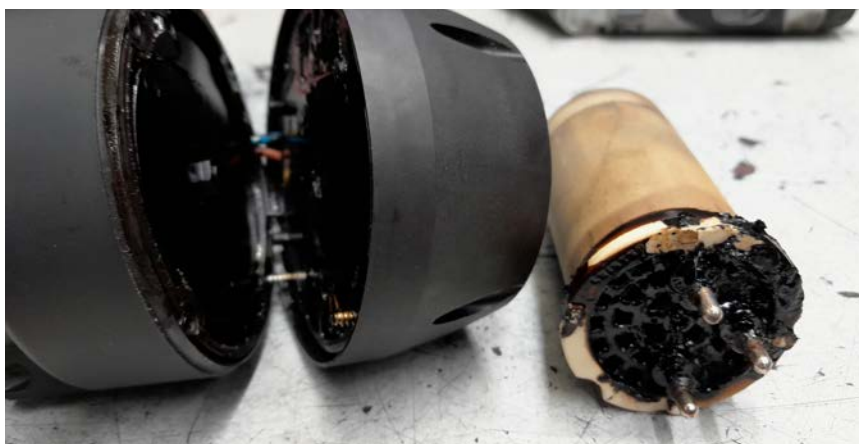
Danni causati da fumi esterni
