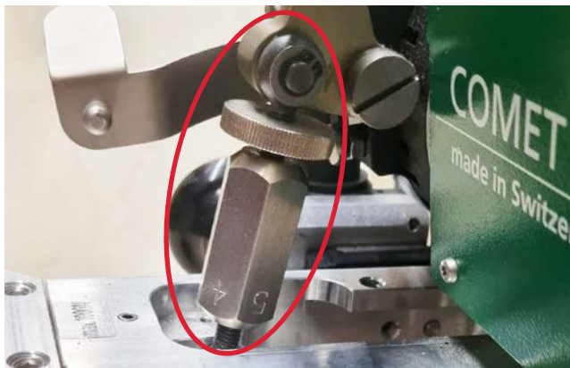
Vis de réglage de la pression tordue en raison d'une pression d'assemblage excessive dans les appareils GEO (l'image ne montre pas les dommages)
