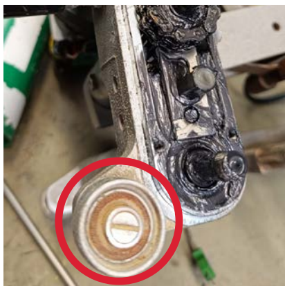
Corrosion des pièces mobiles
