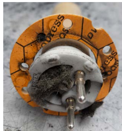
Filtro no instalado
