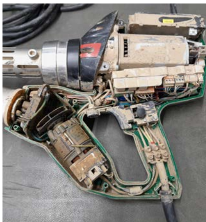
Falta de mantenimiento, dispositivo muy sucio
