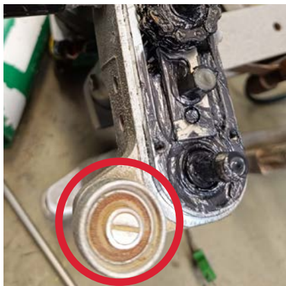
Corrosión de las piezas móviles
