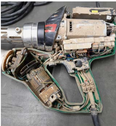
Mangelnde Wartung, Gerät stark verschmutzt
