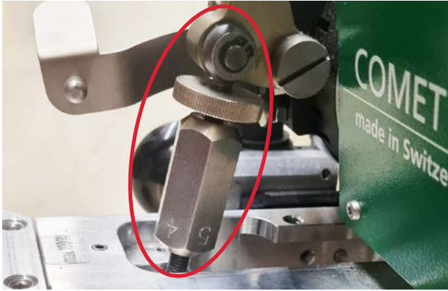
Verbogene Einstellschraube aufgrund übermässigen Anpressdrucks bei GEO-Geräten (das Bild zeigt keine Beschädigung)
