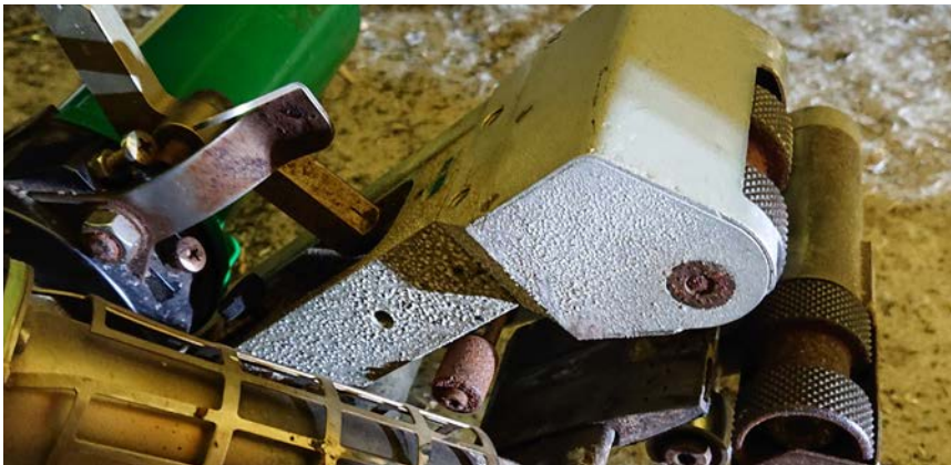
Durch das Schweißen von PVC verursachte Korrosion
