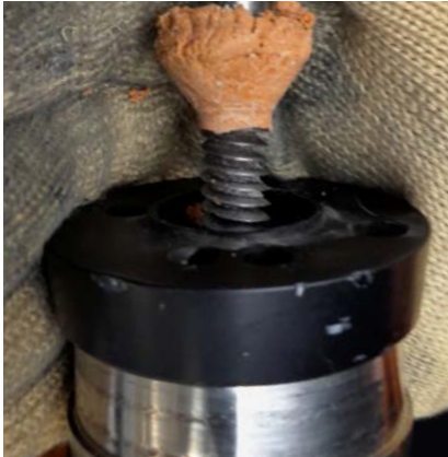
Falsche Handhabung: Es wurden zwei Schweissdrähte gleichzeitig eingeführt, wodurch der Kunststoff zurückgedrückt wurde.
