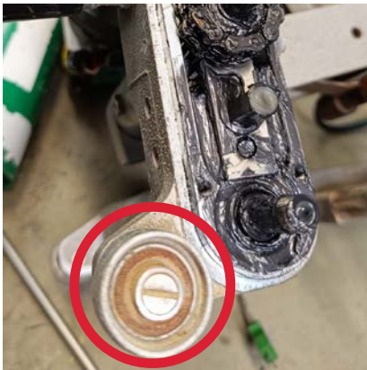
Korrosion beweglicher Teile
