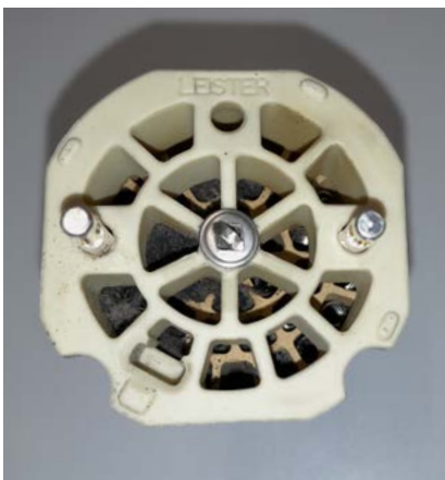
Filter nicht installiert
