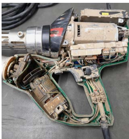
Nedostatečná údržba, zařízení je velmi znečištěné
