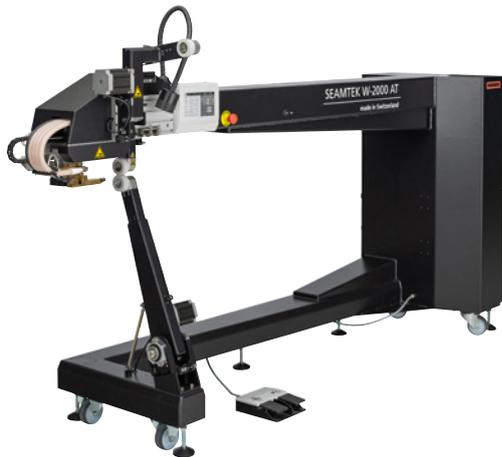
La máquina de soldar SEAMTEK W-2000 AT ofrece a los usuarios aún más espacio que la SEAMTEK W-900 AT. Esto permite una soldadura eficiente y segura de grandes productos hechos de textiles técnicos.
