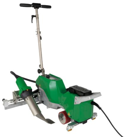
El diseño modular de la VARIANT 700 permite pasar de la soldadura por solapamiento a la soldadura por cinta y soldar hasta 20 m/min, lo que resulta ideal para lonas, carpas y pancartas. Las ruedas Plug and Play, la tecnología de elevación y soldadura y el modo Eco mejoran la eficiencia.
