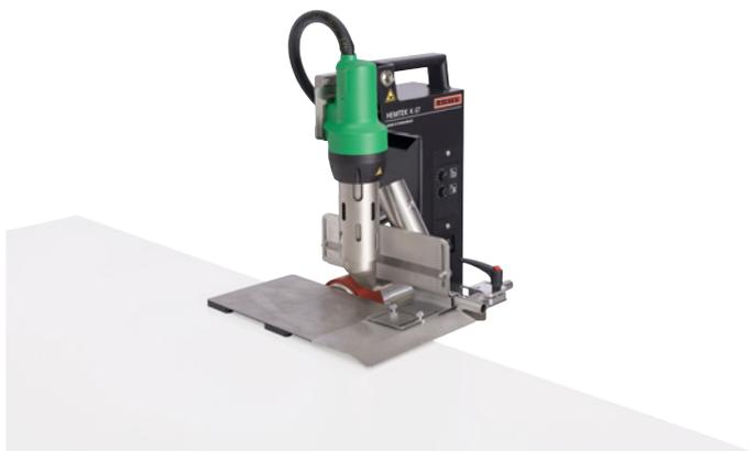
Le HEMTEK K-ST soude les tuyauteries préfabriquées rapidement et efficacement. Le guide facile à utiliser, réglable en continu, permet de produire en toute sécurité des bourrelets de différentes largeurs de banderoles.
