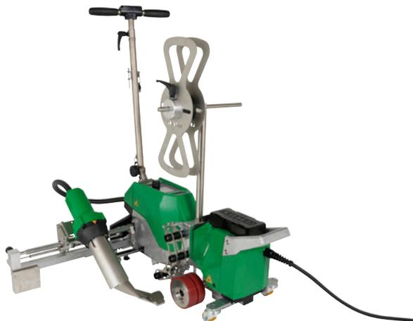
Le VARIANT 704 répond à différents besoins en matière d'alimentation électrique grâce aux options 230V et 400V. Il permet de souder des bandes antivandalisme de 25 mm et de réaliser des applications standard. Le VARIANT 704 est facile à convertir entre l'anti-vandalisme et le soudage par recouvrement.
