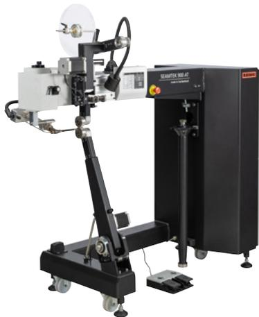
Grâce à la machine à souder SEAMTEK 900 AT, qui nécessite peu d'entretien, même les utilisateurs inexpérimentés parviennent à souder de parfaites soudures, ourlets, bourrelets et bandes. Utilisation intuitive via l'écran tactile.
