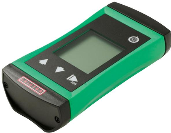
Das Temperaturmessgerät ist ideal für die Baustelle. Es ermöglicht schnelle, präzise Messungen (3/s) zwischen -65 bis 1200 °C. Kompatibel mit Typ-K-Sonden ist es für die Kalibrierung von Extrudern und Heissluftföhns geeignet.
