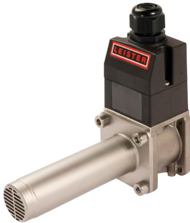
Die LHS 210 SF sind kompakt gebaute Lufterhitzer und mit zahlreichen Düsen (ø 36.5 mm) sowie Zubehör kompatibel. Mittels PWM-Signal kann der Lufterhitzer über ein SSR perfekt in einen Regelkreis eingebunden werden.
