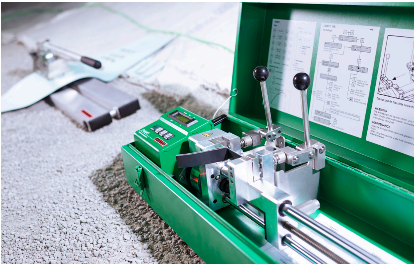
Festigkeitsprüfung einer Überlapp-Schweissnaht mit dem EXAMO 300F USB von Leister
