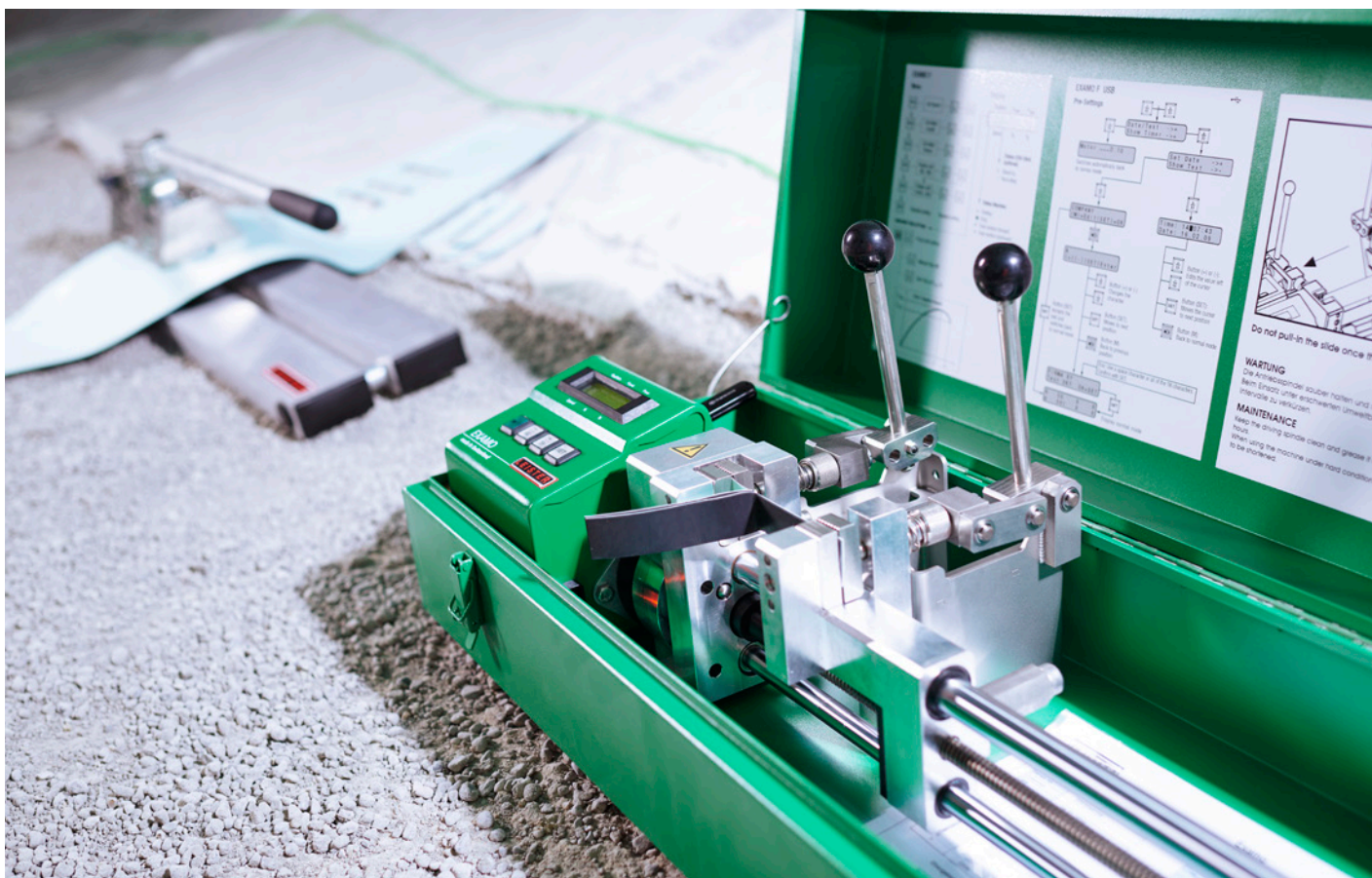
Test di resistenza di un cordone di saldatura a sovrapposizione con EXAMO 300F USB di Leister
