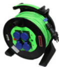
169.190 ケーブルリール 45 m (PUR)、3 x 2.5 mm 2 、T23 (IP55) 230V/16A; 4xT23 (IP55)
