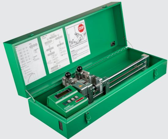
エグザモ 300F USBは、シート材溶接部の剥離接着性、引張強度、せん断強度を検査するための理想的な試験装置であり、世界中でテストされ、証明されています。
