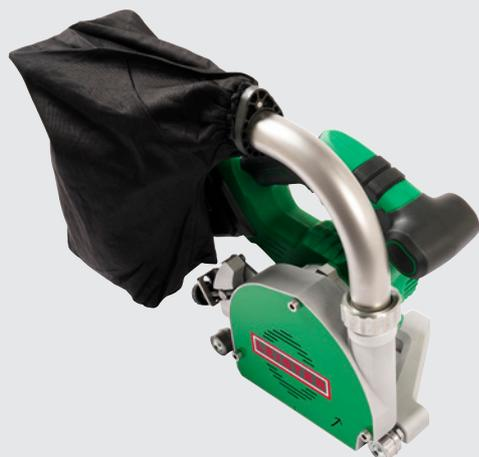
グルーバー500-LPは、リノリウムやゴムなどの弾力性のあるプラスチックや天然素材の床材を敷設する際に、溶接シーム用の溝を加工するバッテリー式の溝切加工機です。コードレスで、汎用の溝切刃を使用しており、素早く作業ができます。
