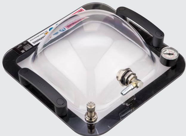
バキュームベルは、実用的なプラスチック製のバキュームベルです。特に埋立工事やトンネル工事では、オーバーラップ溶接部の漏れを確認するために使用されています。
