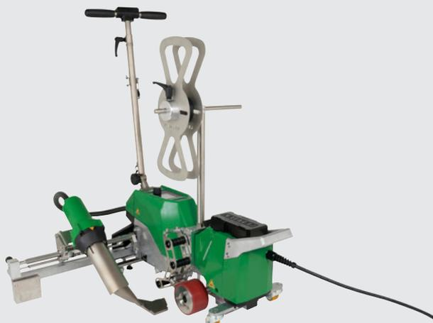
バリエント702は、230Vと400Vのオプションにより、さまざまな電源ニーズを満たします。50mmのテープ溶接に対応し、テープとオーバーラップ溶接を簡単に切り替えることができるため、プロフェッショナルな用途に最適な柔軟性とパフォーマンスを実現します。
