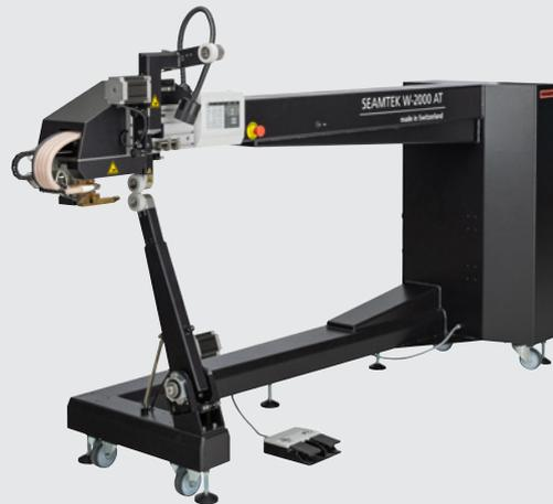
シームテック W-2000 AT溶接機は、シームテック W-900 ATよりもさらに広いスペースをユーザーに提供します。これにより、工業用布地を使用した大型製品の溶接を効率的かつ安全に行うことができます。
