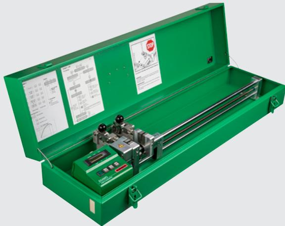
エグザモ 600F USBは、高弾性膜の溶接部の剥離接着性、引張強度、せん断強度などを調べるのに最適な試験機です。査定試験されており、世界中で実証されています。
