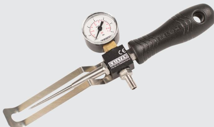
リークテスターは、テストチャンネルを用いて継ぎ目の密着具合を確認するための信頼性の高い圧縮空気試験機です。土木関連、トンネル、埋立地に有用な溶接シームの品質保証を目的として開発されました。
