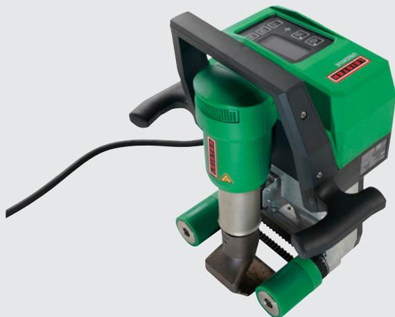
La saldatrice semiautomatica UNIDRIVE 500 combina la saldatura manuale a quella automatica, in un pratico dispositivo per la saldatura di membrane termoplastiche. Sviluppata per saldare in verticale e orizzontale è perfetta per piccoli tratti sul piano e dettagli sulle coperture.
