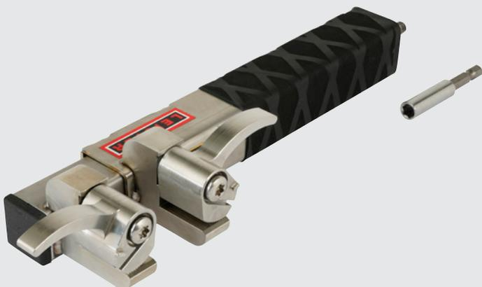
Il tester EXAMO 100 è perfetto per effettuare veloci prove di peeling. Strumento leggero e portatile che non richiede l'utilizzo di energia elettrica, grazie all'utilizzo di un avvitatore a batteria.
