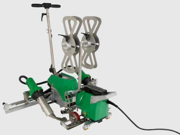
L'efficiente saldatrice Spriegel VARIANT 708 convince per il suo sistema a doppio ugello, che riduce i tempi di saldatura e passa in modo flessibile da un tipo di saldatura all'altro. Supporta anche la saldatura del nastro antivandalico, ideale per i teloni dei camion.
