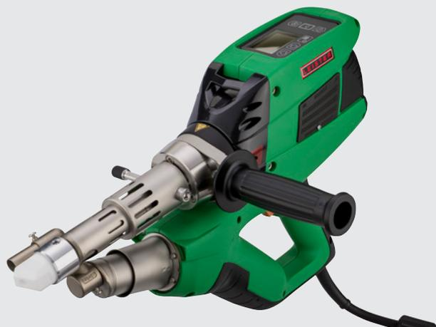
L'estrusore WELDPLAST S1 è funzionale nelle sue applicazioni. La temperatura dell'aria preriscaldata e della plastica sono regolate separatamente, il che garantisce una procedura di saldatura stabile e risultati di saldatura di alta qualità. L'estrusore WELDPLAST S1 lavora materiali come PP, PE, PVC-U e PVDF.
