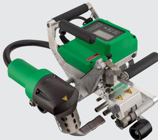
La saldatrice automatica TWINNY T5 rende la saldatura della plastica facile e pratica, sia che si tratti di saldature di geomembrane di vario spessore in opere interrato, costruzione di bacini idrici, costruzione di miniere, ingegneria delle discariche o di vasche per l'allevamento ittico.
