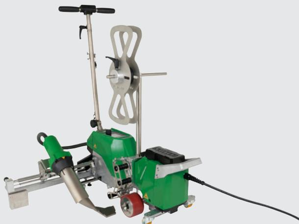
La VARIANT 702 soddisfa diverse esigenze di alimentazione con opzioni a 230V e 400V. Supporta la saldatura a nastro da 50 mm e si converte facilmente tra saldatura a nastro e saldatura a sovrapposizione, garantendo flessibilità e prestazioni ottimali per l'uso professionale.
