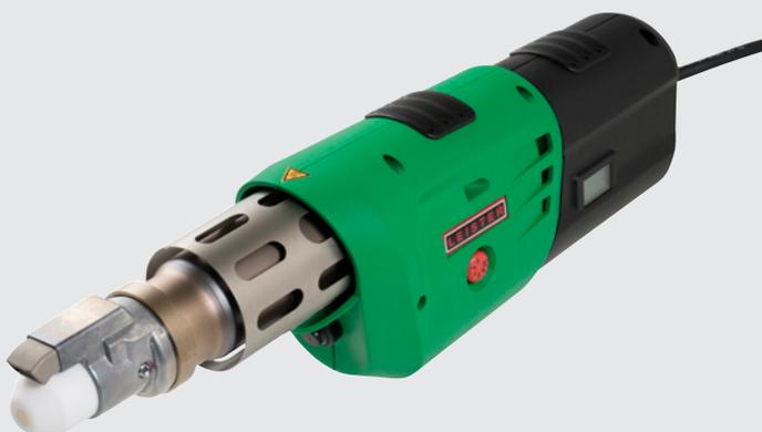
L'estrusore FUSION 1 è particolarmente facile da maneggiare. L'inserimento del filo su entrambi i lati e il pattino di saldatura rotante garantiscono la massima flessibilità di saldatura. È adatto per le riparazioni plastiche, così come per la costruzione di tubazioni e contenitori.
