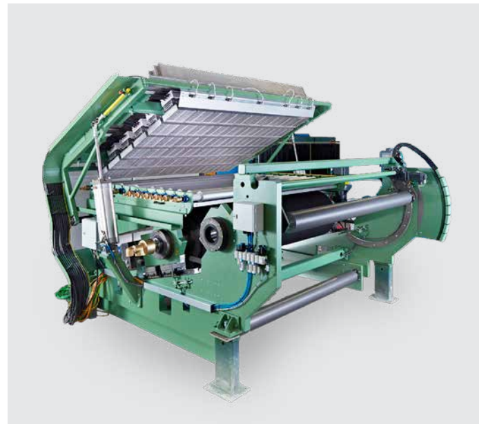
纺织品后整理机器上使用莱丹的 KRELUS 红外加热器 © Kampf LSF GmbH, 2017
