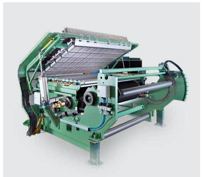
KRELUS infraroodstralers van Leister in gebruik in een textielafwerkingsmachine | © Kampf LSF GmbH, 2017
