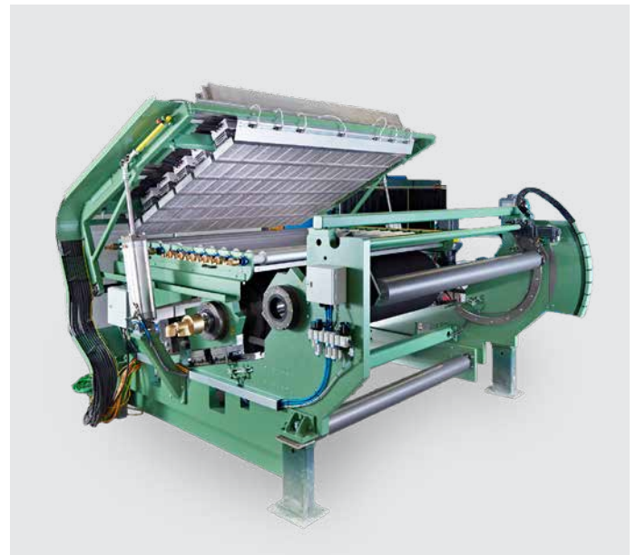
Émetteurs IR KRELUS de Leister utilisés dans une machine de finition textile © Kampf LSF GmbH, 2017
