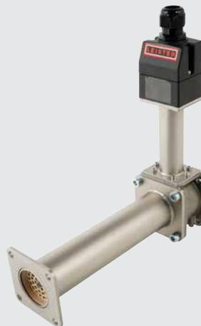
Il riscaldatore d'aria tubolare di medie dimensioni LHS 410 DF-R HT offre elevati volumi d'aria, una temperatura massima di ingresso dell'aria di 350 °C e una temperatura di uscita fino a 900 °C. Può essere facilmente integrato nei sistemi di tubazioni industriali.
