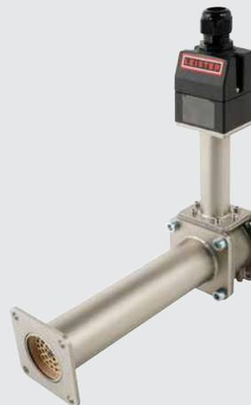
LHS 210 DF-R HT è un riscaldatore d'aria a doppia flangia ad alta temperatura, adatto per il ricircolo dell'aria calda - fino a 900 °C di temperatura di uscita dell'aria con una temperatura massima di ingresso dell'aria di 350 °C.
