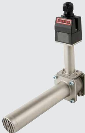
LHS 210 SF-R HT è un riscaldatore d'aria compatto a flangia singola ad alta temperatura, adatto per il ricircolo dell'aria calda. Raggiunge una temperatura massima di uscita dell'aria di 900 °C con una temperatura di ingresso dell'aria di 350 °C.
