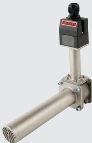
Der LHS 210 SF-R HT ist ein kompakter Hochtemperatur-Singelflansch-Lufterhitzer, der Heissluft-recyclingfähig ist. Er erreicht eine max. Luftaustrittstemperatur von 900 °C bei einer Lufteintrittstemperatur von 350 °C.
