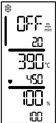
Schalten Sie die Heizung mit der Taste *Heizung Ein/Aus* (31) aus, damit die **Schweißdüse (11)** abkühlt.
