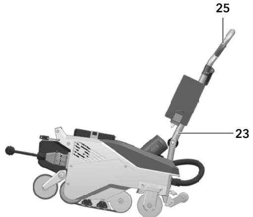
Zur Positionierung des Heissluft-Schweissautomaten drücken Sie auf den **Führungsstab (23, 25)** und rollen das Gerät so in die gewünschte Schweissposition.
