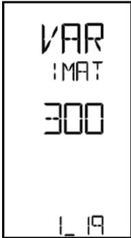
Nach dem Einschalten wird im Display der **Bedieneinheit (2)** für kurze Zeit das **Startbild** mit der Gerätebezeichnung, der Versionsnummer und dem aktuellen Software-Release angezeigt.
