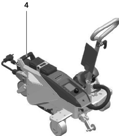
Zum Anheben des Heissluft-Schweissautomaten von Hand benutzen Sie den **Traggriff (4)**.
