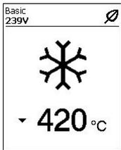
Wenn Sie den Eco-Mode aktiviert haben und das Gerät während der festgelegten Zeitspanne inaktiv bleibt, erfolgt automatisch ein Wechsel in den Modus Standby-Timer. Die Luftmenge wird automatisch auf 45 % reduziert. In der der Arbeitsanzeige (41) wird der Standby-Timer mit dem entsprechenden Symbol dargestellt.
