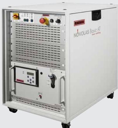
NOVOLAS™ BASIC AT est conçu pour être intégré dans les chaînes de production. Grâce à sa conception modulaire cohérente, le système laser peut très bien être configuré pour répondre à différentes exigences.
