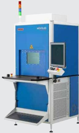
Le système de soudage laser NOVOLAS™ WS-AT est de conception modulaire et d'application universelle. Il peut être équipé de différentes manières comme un poste de travail manuel et peut être adapté à des applications et des processus spécifiques au client.
