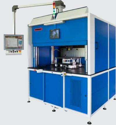
MAXI est un système de soudage laser modulaire et universel, spécialisé dans les gros composants. Il peut être équipé de nombreuses manières différentes comme un poste de travail manuel et peut être adapté à des applications et des processus spécifiques au client.
