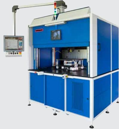
MAXI ist ein modulares, universell einsetzbares Laserschweissssystem und spezialisiert auf grosse Bauteile. Es kann als Handarbeitsplatz ausgestattet werden und ist auf kundenspezifische Anwendungen und Prozesse einstellbar.
