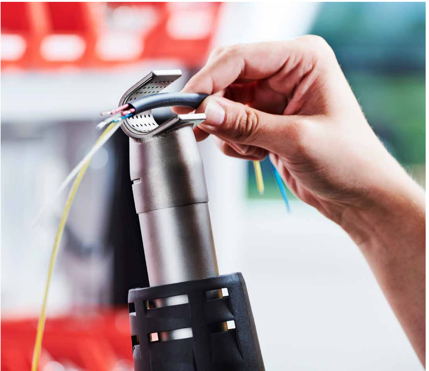
使用 Leister SOLANO AT 的进行电缆收缩工序
