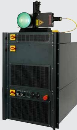
Le système modulaire BASIC M est un système de soudage laser destiné à être intégré dans des installations de production industrielle. La configuration de base BASIC M comprend l'UNITE PRINCIPALE, l'optique et le laser.
