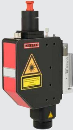
Le Globo Optic L est conçu pour le soudage sans fin de contours en 2 ou 3 dimensions. La boule de verre à coussin d'air de l'optique est utilisée comme lentille de focalisation et pour l'application de la pression. De plus, l'optique est équipée d'une mesure de la puissance du laser et d'un pyromètre.
