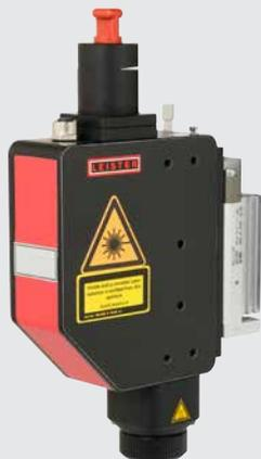
Il Globo Optic L è progettato per la saldatura continua di contorni 2 e 3-D. La sfera di vetro a cuscinetto d'aria dell'ottica è usata come lente di messa a fuoco e per l'applicazione della pressione. Inoltre, l'ottica è dotata di una misurazione della potenza del laser e di un pirometro.
