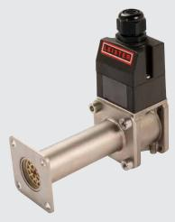
Les LHS 210 DF sont des réchauffeurs d'air compacts. Les brides des deux côtés permettent de les installer facilement dans des systèmes de tuyauterie. L'appareil peut être parfaitement intégré dans un closed loop à l'aide d'un signal PWM via un SSR.
