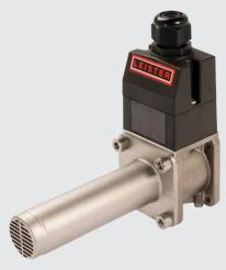
Les LHS 210 SF sont des réchauffeurs d'air compacts qui conviennent à toute une gamme de buses (ø 36.5 mm) et d'accessoires. Ils peuvent être parfaitement intégrés dans un closed loop à l'aide d'un signal PWM via un SSR.
