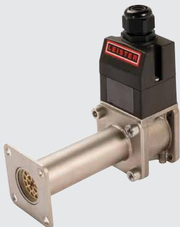
Gli LHS 210 DF sono riscaldatori ad aria compatti. Grazie alle flange su entrambi i lati, possono essere facilmente integrati nei sistemi di tubature. L'apparecchio può essere perfettamente integrato in un circuito chiuso utilizzando un segnale PWM tramite SSR.
