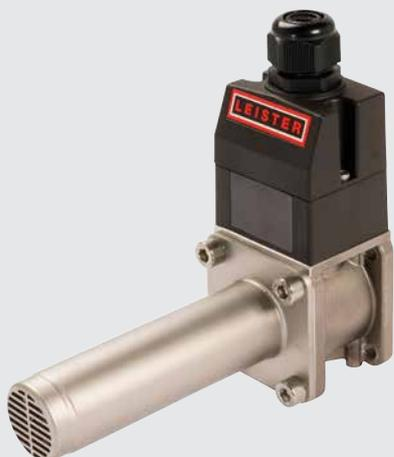
Gli LHS 210 SF sono riscaldatori ad aria compatti e compatibili con una gamma di ugelli ( $\varnothing$  36.5 mm) e accessori. Possono essere perfettamente integrati in un circuito chiuso utilizzando un segnale PWM tramite SSR.
