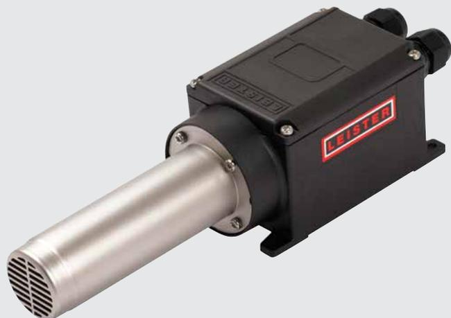
LHS 21S CLASSIC è disponibile con potenze di 1-2 kW. È dotato di un sistema di rilevamento del surriscaldamento dell'elemento riscaldante e dell'apparecchio con contatto per l'allarme. Può essere perfettamente integrato nel circuito chiuso utilizzando un segnale PWM tramite SSR.
