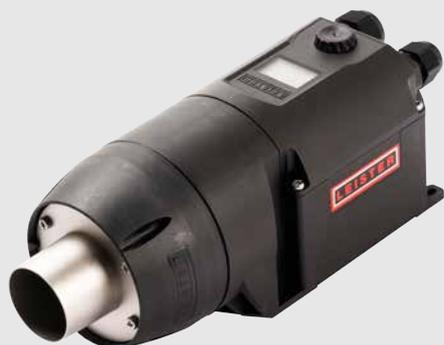
La soufflante du MONO 6 SYSTEM est petite mais très puissante grâce à son volume d'air élevé, qui peut atteindre 600 l/min ou 21.2 cfm. Elle est équipée d'un moteur sans balais nécessitant peu d'entretien, ce qui la rend apte à fonctionner en continu.
